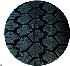
Una prueba fácil: Introduzca un centavo en una de las ranuras de la banda. Si parte de la cabeza de Lincoln queda cubierta por la banda, quiere decir que usted está manejando con una banda suficientemente profunda. Si puede ver la cabeza entera, necesita comprar una llanta nueva.
